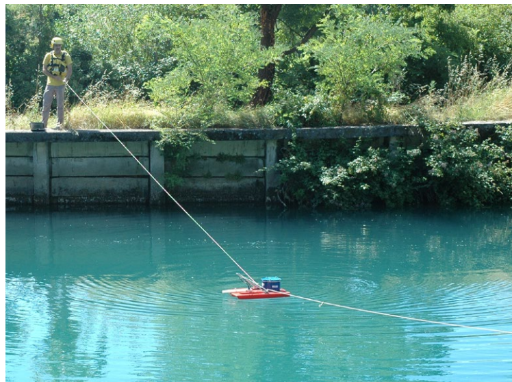
Figura 7.1 Misura di portata al 3° ramo delle Sorgenti del Timavo. La strumentazione ADCP è montata su un piccolo natante e viene trascinata da due operatori più volte lungo la sezione di misura, i dati vengono registrati e controllati in tempo reale attraverso un pc portatile dall'operatore posto a riva.
