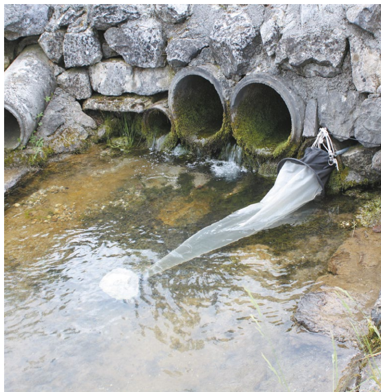
Figura 6.4 Campionamento della fauna sotterranea portata in superficie dalla corrente alla sorgente (drift)
