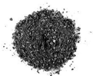
Figura 3.19 – Substrato Optigrün tipo I per inverdimenti estensivi, costituito da lapillo, pomice, laterizio trattato, humus di corteccia, compost vegetale (fonte [www.optigrun.it](http://www.optigrun.it)).
