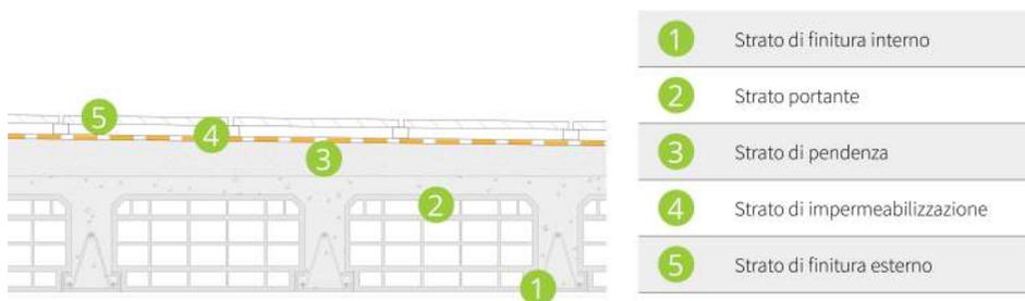
Figura 4.3 – Rappresentazione strati funzionali soluzione SF2 – strato di finitura in quadrotti.
