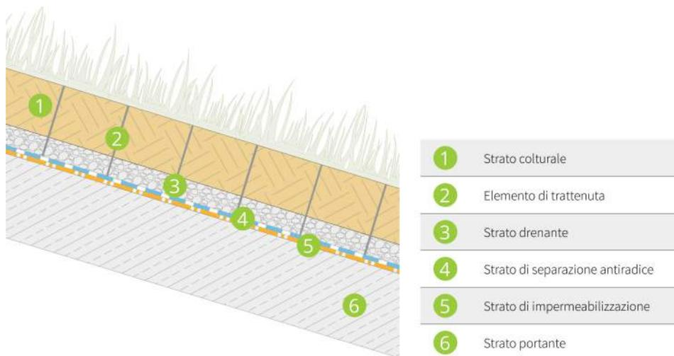
Figura 3.10 – Soluzione tecnologica tipo per un sistema di verde intensivo leggero su copertura inclinata e strato di drenaggio naturale.
