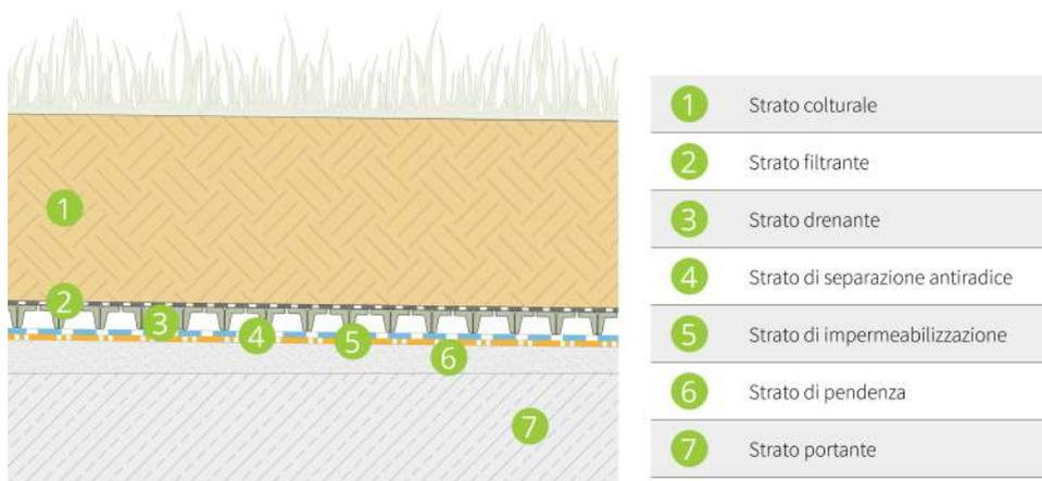
Figura 3.14 – Soluzione tecnologica tipo per un sistema di verde intensivo pesante su copertura piana e strato di drenaggio artificiale.
