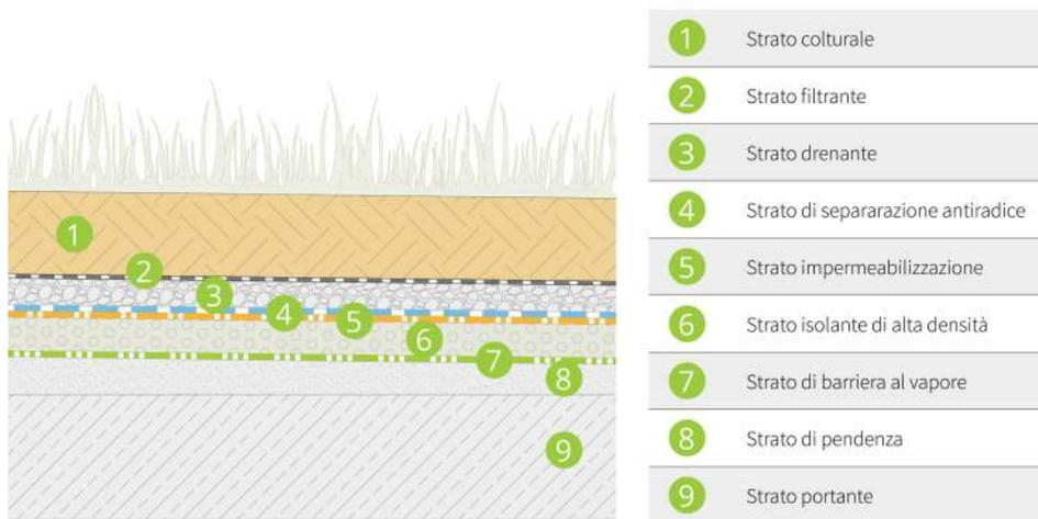
Figura 3.4 – Soluzione tecnologica tipo per un sistema di verde intensivo leggero su copertura piana con presenza di strato di isolamento termico e strato di drenaggio naturale.
