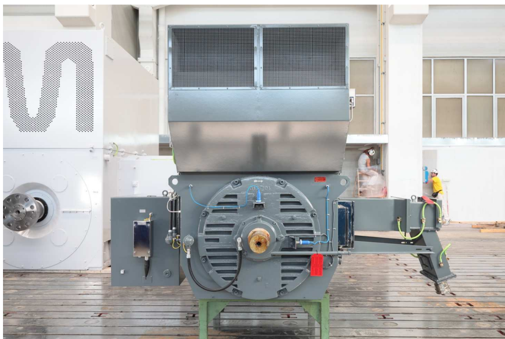
Fig. 1.10: Vista frontale di un TEAAC (CT 355 L2). In evidenza il particolare del silenziatore d'uscita aria.
