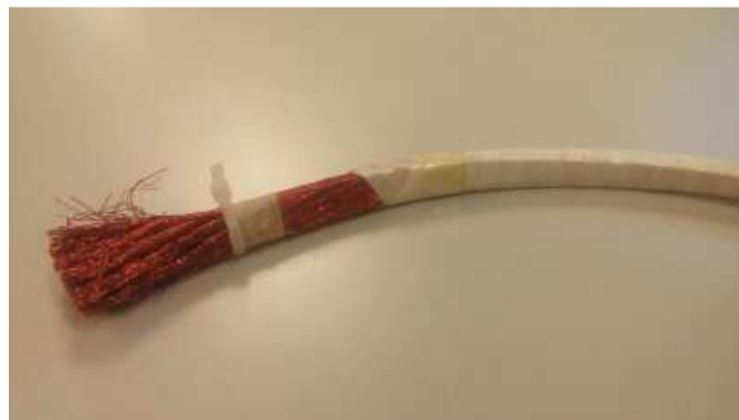
Fig. 4.21: Spira in conduttore litz. Nell'immagine è possibile vedere anche i conduttori elementari.
