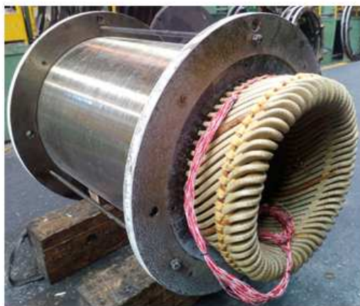
Fig. 2.73: Statore lato opposto accoppiamento e distribuzione delle PT100.
