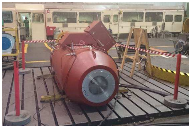
Fig. 2.53: Vista lato opposto accoppiamento della macchina in fase di prova.
