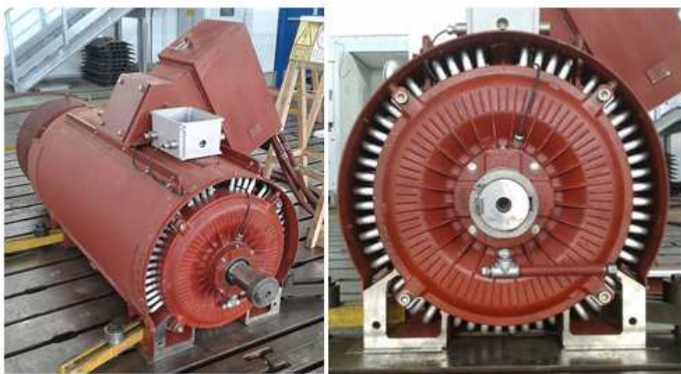
Fig. 2.78: Vista in prospettiva e frontale del CA+ 400 L4 caratterizzato da una potenza nominale di 710 kW.
