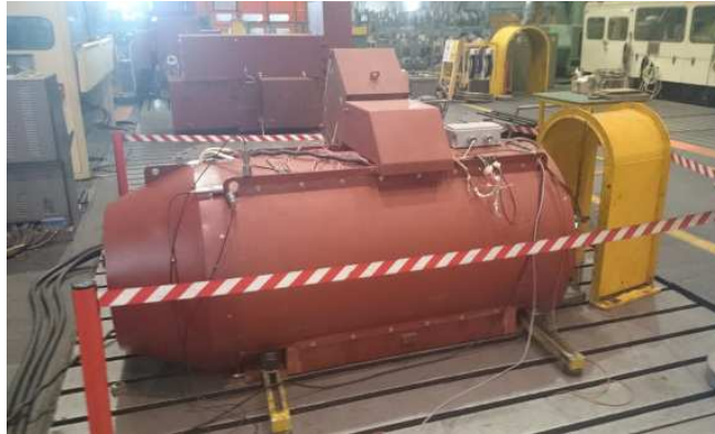
Fig. 2.51: Vista laterale del CA+ 500 L4 in fase di prova.
