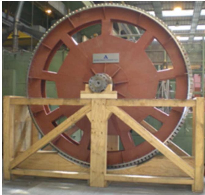
Fig. 4.19: Rotore dopo il montaggio delle espansioni polari e delle matrici dei magneti.
