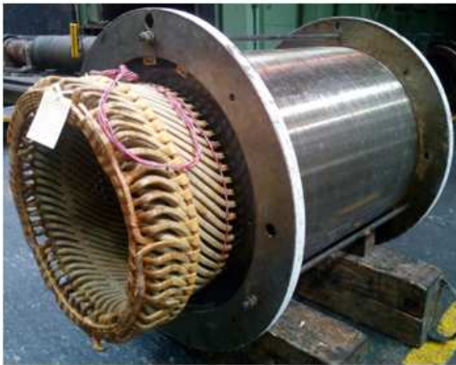
Fig. 2.72: Statore lato accoppiamento e distribuzione delle PT100.
