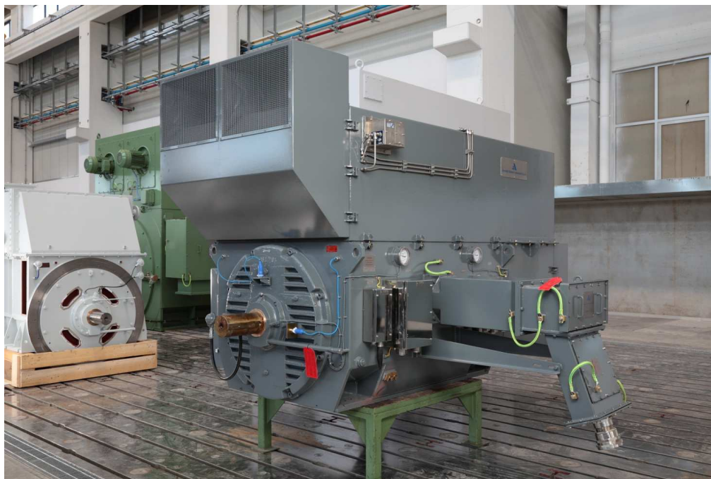
Fig. 1.9: Vista laterale di un TEAAC (CT 355 L2).
