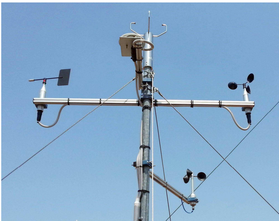
Stazione DMG di Trieste, tetto dell'ISIS Nautico, piazza Hortis, 1: piranometro Kipp&Zonen CM11.
