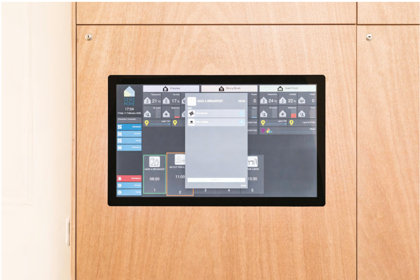
06. Agenda visiva integrata. Il sistema permette di gestire la domotica SENSHome e di programmare delle sequenze di azioni da svolgere abbinando l'accensione dei pittogrammi luminosi secondo un ordine e una durata stabiliti | Integrated Visual Agenda. The system makes it possible to manage SENSHome automation and to program sequences of actions to be carried out by combining the switching of the backlit pictograms according to a set order and duration. Schirra/Giraldi
