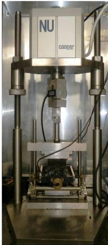
Figura 7.4: Strumentazione di laboratorio per test ITSM.
