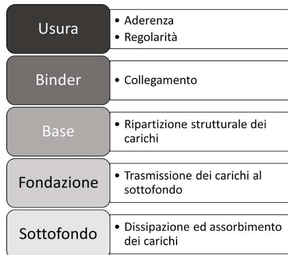
Figura 2.1: Successione di strati in una pavimentazione flessibile.
