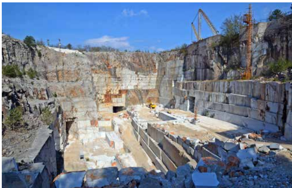
Slika 4.2.11: Kamnolom Lipica 1 leži severovzhodno od znane Kobilarne Lipica. V tem kamnolomu izkoriščajo velike bloke masivnega krednega apnenca. Kamnolom se nahaja v gospodarsko najperspektivnejšem delu formacije Lipiškega apnenca v severnem krilu Lipiške sinklinale, velike skledaste gube z osjo, ki je rahlo nagnjena proti jugovzhodu (foto: Matevž Novak)
