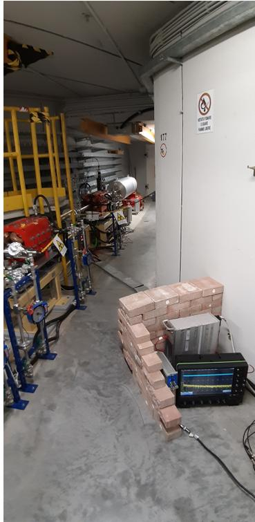
Figura 2.21: Oscilloscopio protetto da mattoni in prossimità della zona DBD
