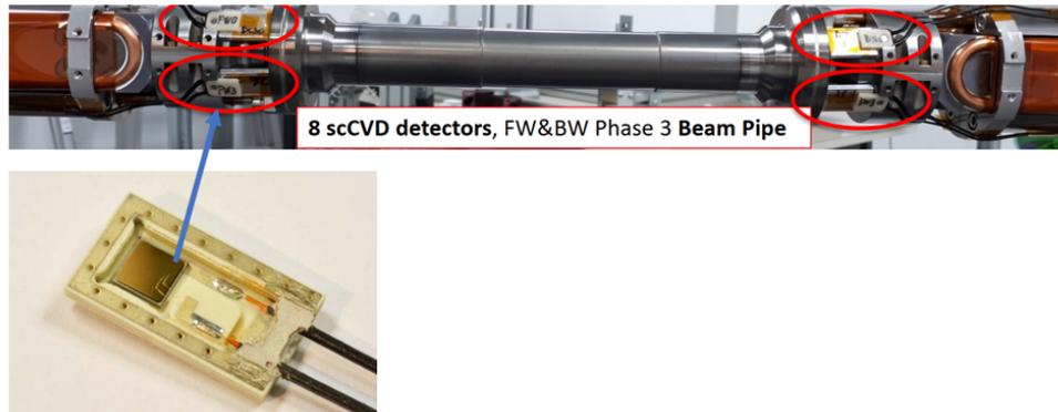
Figura 3.1: Sensori al diamante installati a ridosso della camera del detector Belle II
