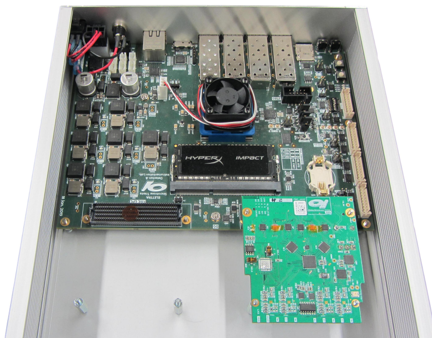
Figura 2.9: Scheda universale con la scheda periferica montata.
