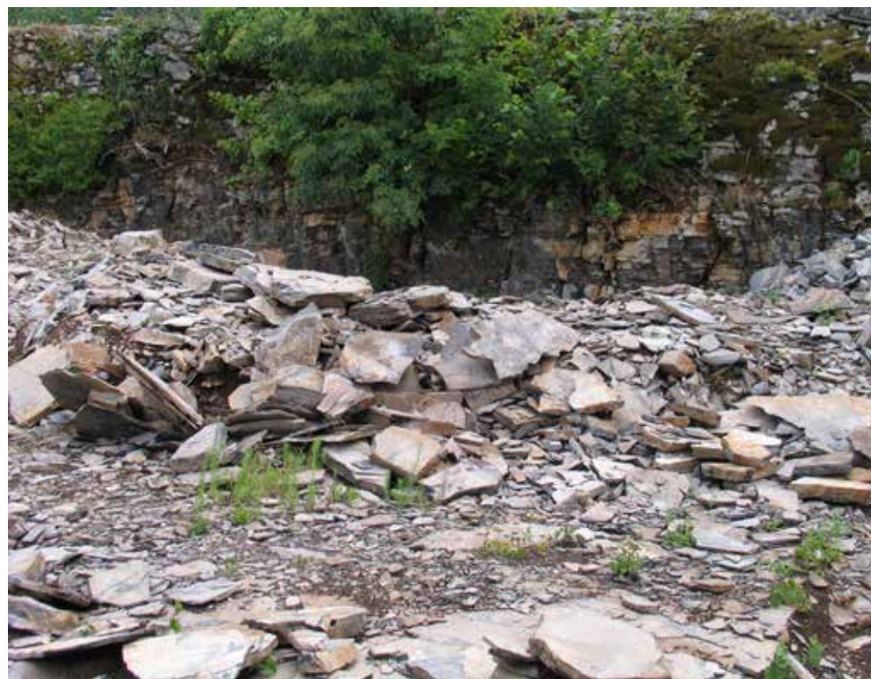
Figura 5.1.6: Cava abbandonata presso Gabrovica (Slovenia), dove si estraevano i calcari fittamente stratificati della formazione di Komen da utilizzare per la realizzazione di tetti e pavimenti (Foto: Bogdan Jurkovšek)
