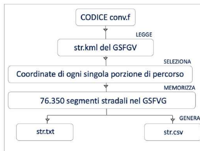
Fig. 2.9) Descrizione delle fasi svolte per individuare i nodi nel grafo "GSFVG" nel primo programma di calcolo denominato con la sigla: "conv.f".
