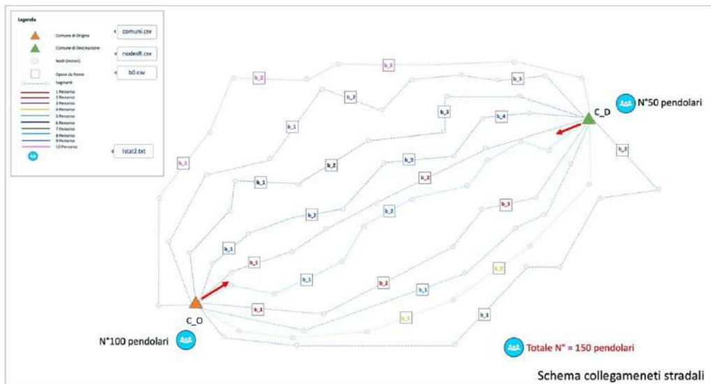
Fig. 2.23) Schema di rappresentazione per un collegamento stradale del Modello MRS formato da un nodo iniziale e finale, un numero di percorsi pari a 10, un numero di ponti pari a 25 assegnati agli stessi 10 percorsi e un numero di pendolari pari a 150.
