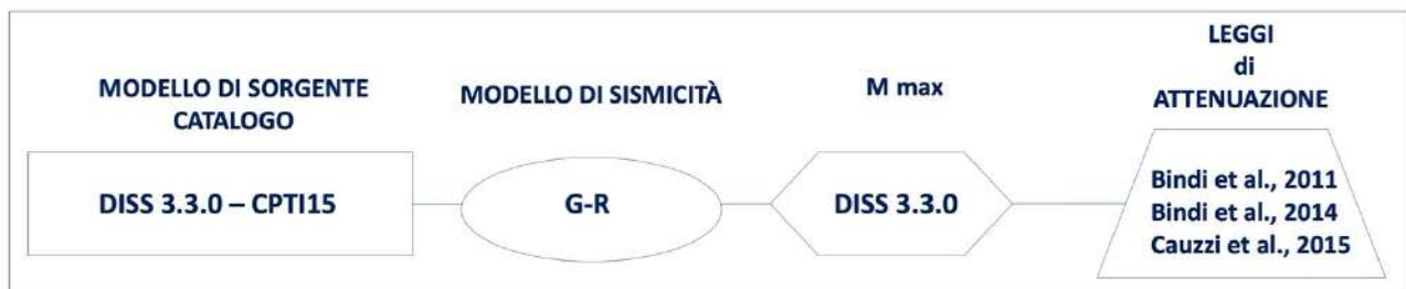
Fig. 2.32) Schema concettuale per l'analisi della pericolosità sismica, composto da: DISS 3.2.1 e dal catalogo CPTI15 (Rovida et al., 2022), dal modello di sismicità (Gutenberg-Richter G-R); dalla magnitudo massima associata a DISS 3.2.1 infine sono state utilizzate le relazioni di attenuazioni di (Bindi et al., 2011; Bindi et al., 2014; Cauzzi et al., 2015).
