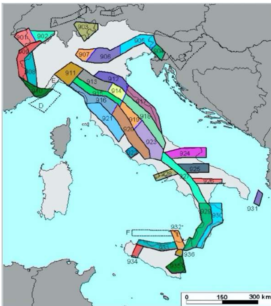
Fig. 1.14) Zonazione sismogenetica ZS9; le diverse zone sono individuate da un numero, le zone individuate con una lettera non sono state utilizzate nella valutazione della pericolosità sismica (fonte: INGV-Gruppo di lavoro 2004 (Meletti et al., 2008).
