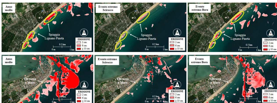
Figura 6.8: Erosioni lungo la spiaggia di Lignano. La prima riga evidenzia in giallo le aree di erosione comuni a tutte e tre le simulazioni nella zona di Lignano Pineta, mentre la seconda riga riporta il tratto più vicino alla bocca.
