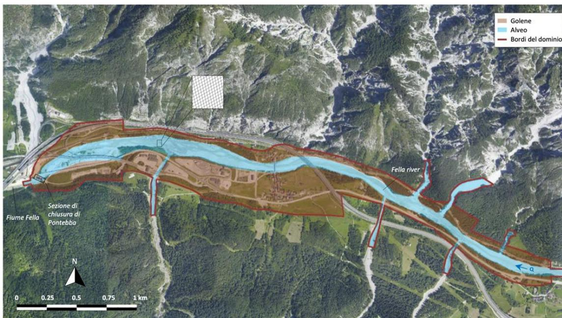
Figura 4.19: Dominio della mesh bidimensionale per le simulazioni idrauliche necessarie per la costruzione della scala delle portate nella sezione trasversale a Pontebba.
