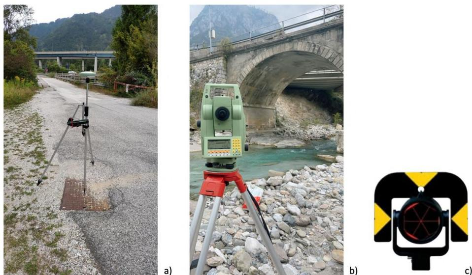
Figura 4.4: GPS *LEICA System 500 – SR520* (a), stazione totale *LEICA TPS TCRA 1103* (b) e prisma di tipo standard (c).
