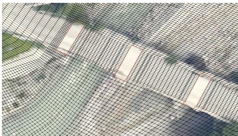
Figura 4.18: Dettaglio delle celle irregolari della mesh bidimensionale utilizzata nella modellazione idraulica. In figura è riportata la sezione di chiusura di Pontebba.
