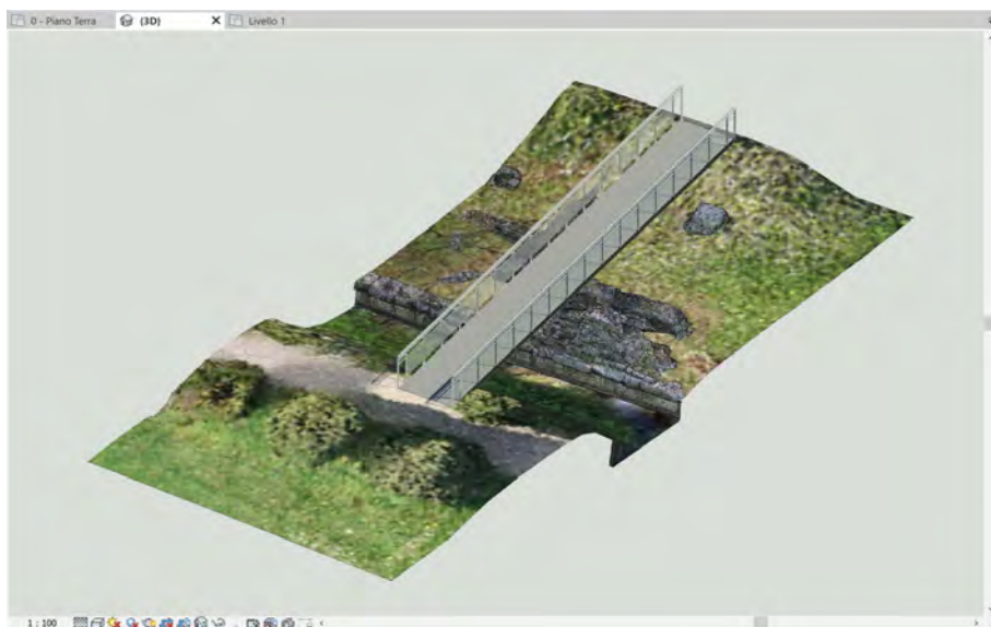
Figura 6. Porzione del “modello texturizzato” del porto fluviale romano con l’inserimento della passerella in Revit, rielaborato con un programma di fotoritocco per simulare la presenza della texture.
