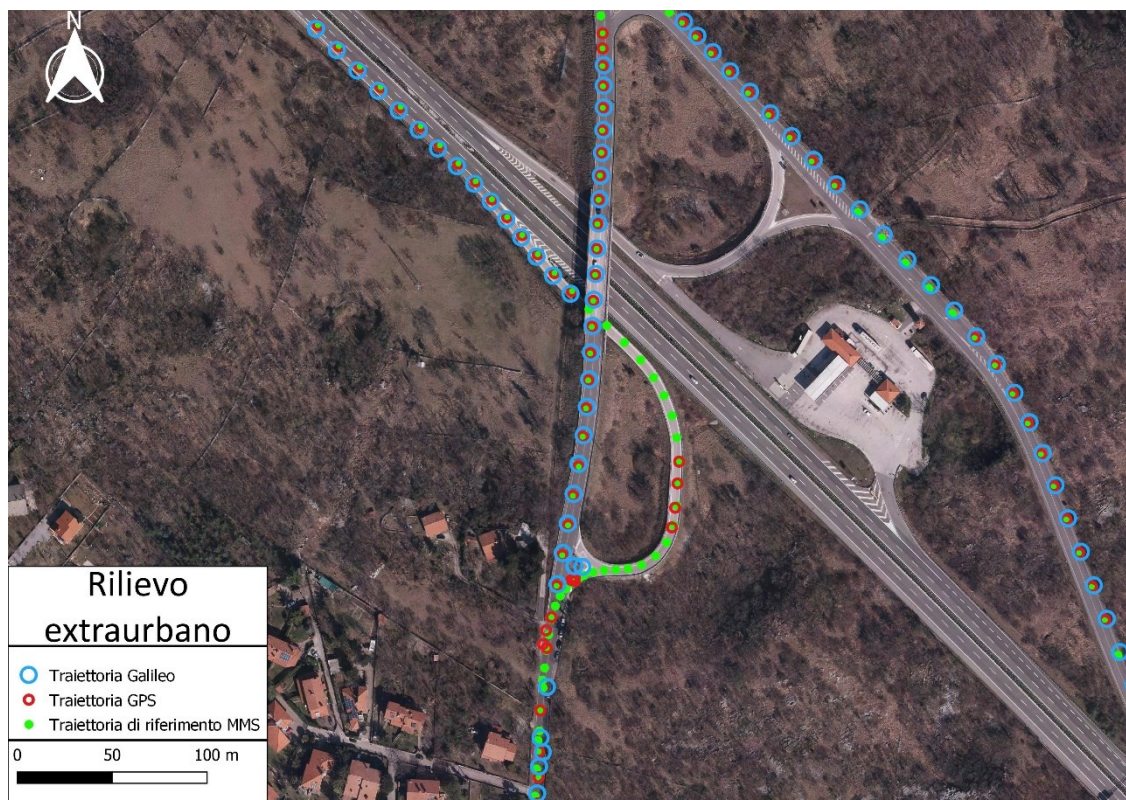
Figura 4.140 Dettaglio delle traiettorie Galileo (in azzurro) e GPS (in rosso) rispetto a quella di riferimento MMS (in verde)
