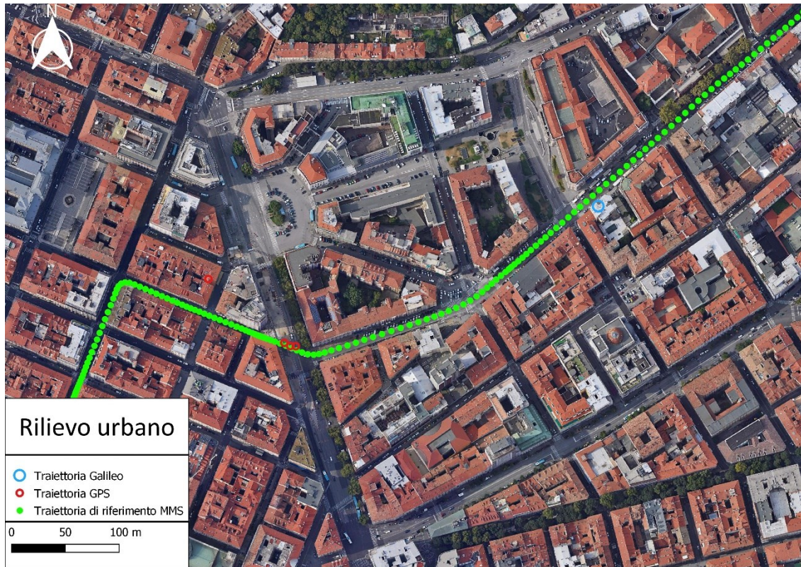
Figura 4.111 Dettaglio delle traiettorie Galileo (in azzurro) e GPS (in rosso) rispetto a quella di riferimento MMS (in verde)
