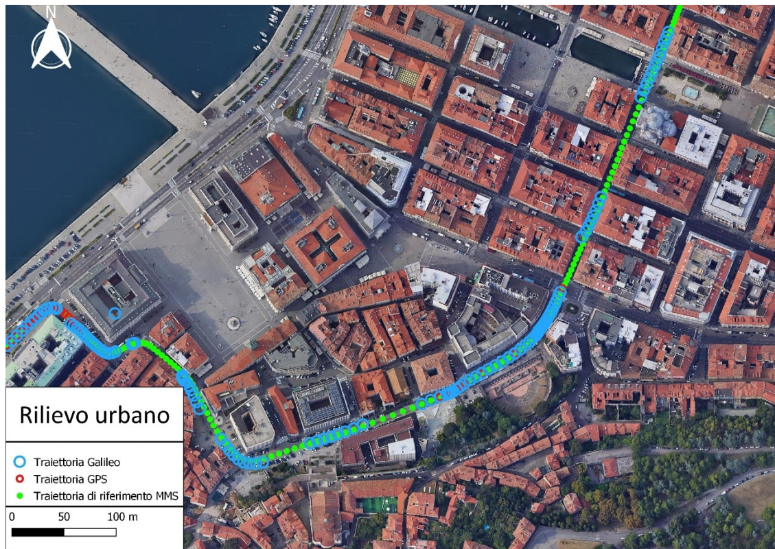
Figura 4.54 Dettaglio delle traiettorie Galileo (in azzurro) e GPS (in rosso) rispetto a quella di riferimento MMS (in verde)
