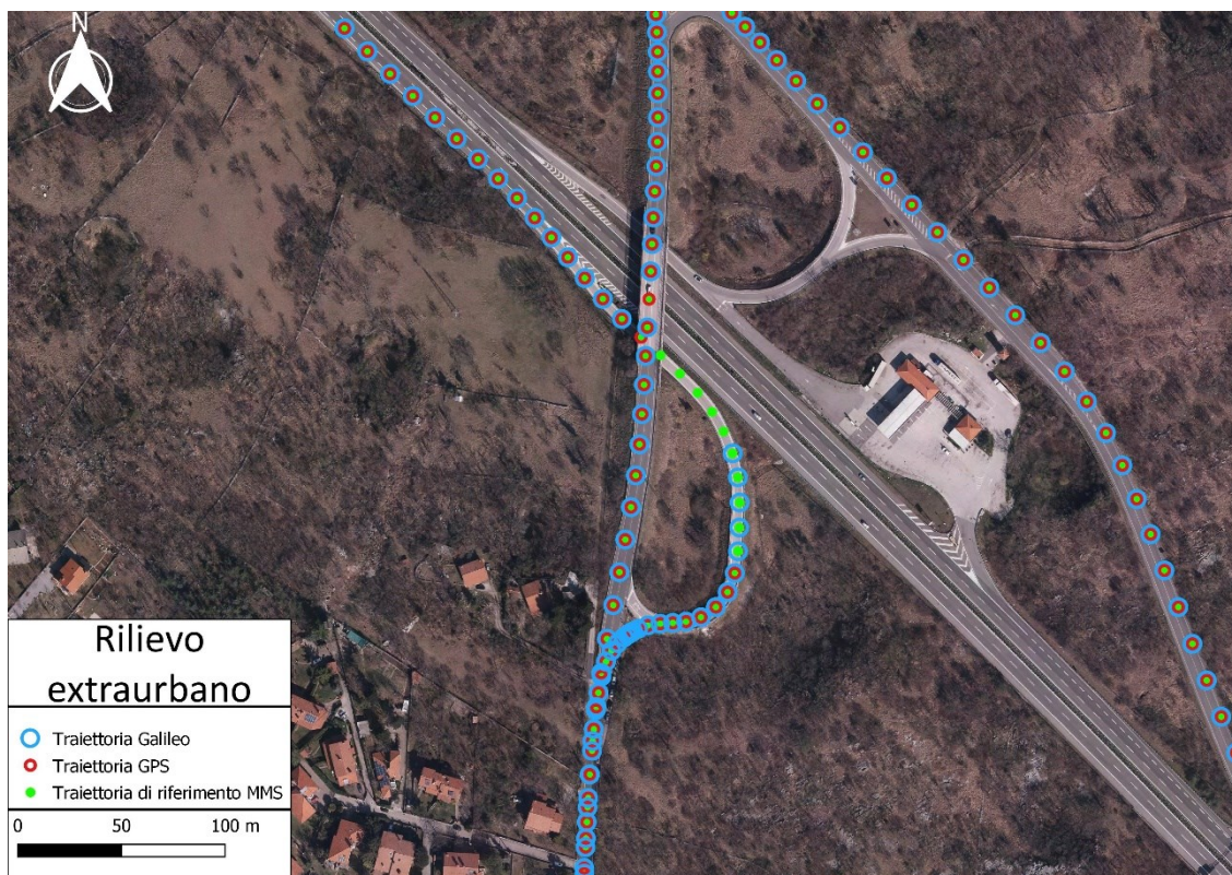
Figura 4.82 Dettaglio delle traiettorie Galileo (in azzurro) e GPS (in rosso) rispetto a quella di riferimento MMS (in verde)
