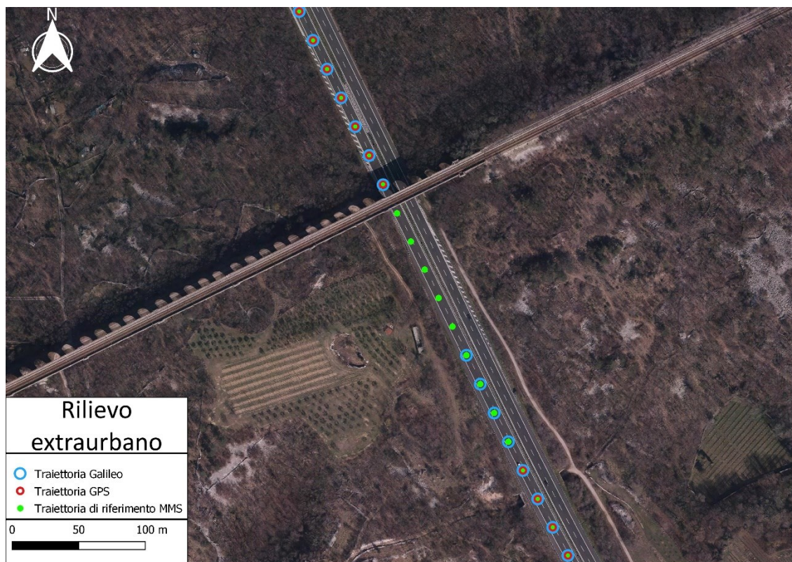
Figura 4.83 Dettaglio delle traiettorie Galileo (in azzurro) e GPS (in rosso) rispetto a quella di riferimento MMS (in verde)
