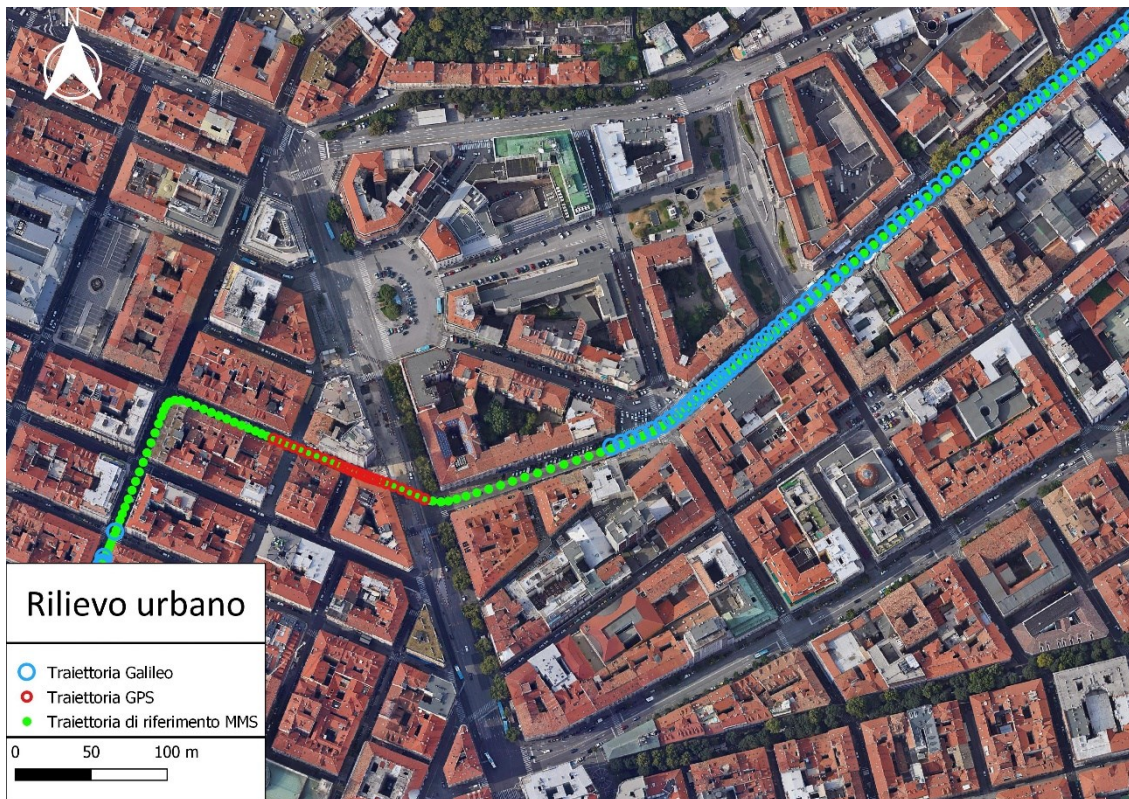
Figura 4.53 Dettaglio delle traiettorie Galileo (in azzurro) e GPS (in rosso) rispetto a quella di riferimento MMS (in verde)
