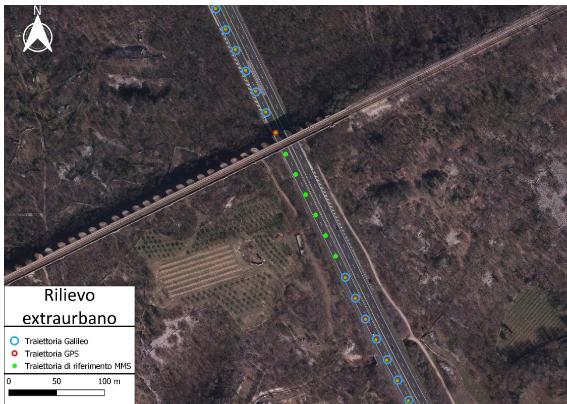
Figura 4.141 Dettaglio delle traiettorie Galileo (in azzurro) e GPS (in rosso) rispetto a quella di riferimento MMS (in verde)
