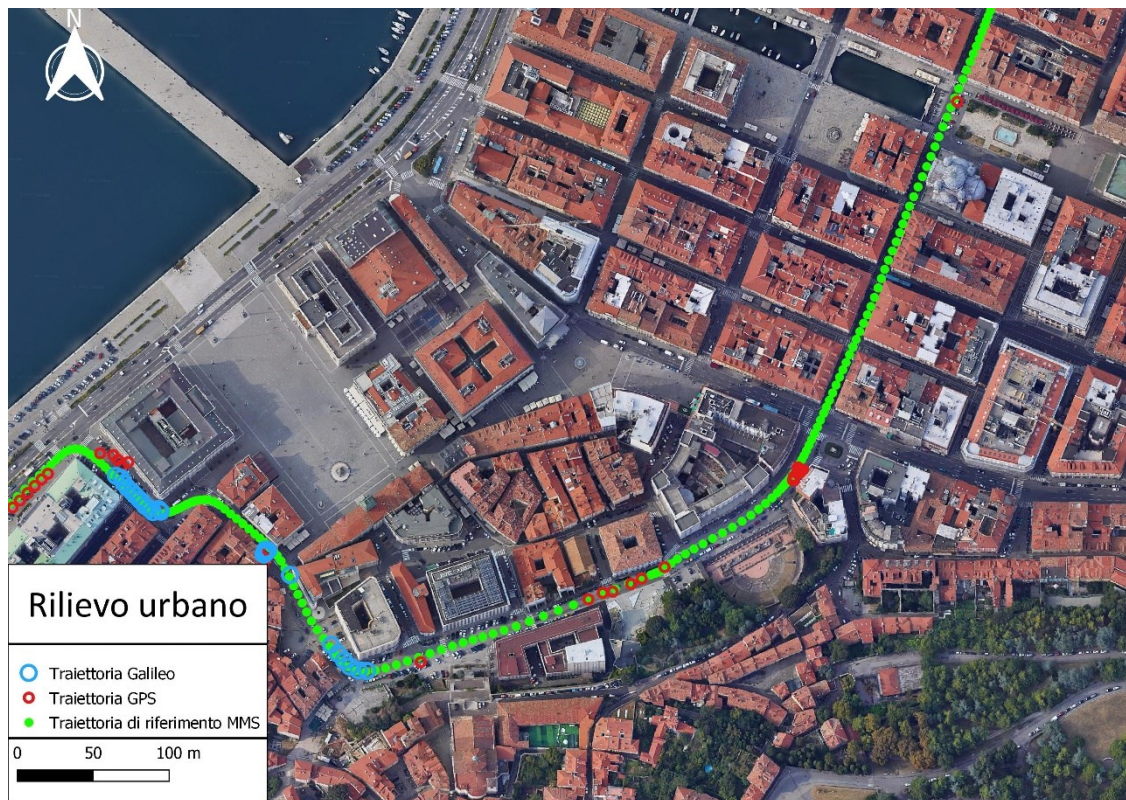
Figura 4.112 Dettaglio delle traiettorie Galileo (in azzurro) e GPS (in rosso) rispetto a quella di riferimento MMS (in verde)
