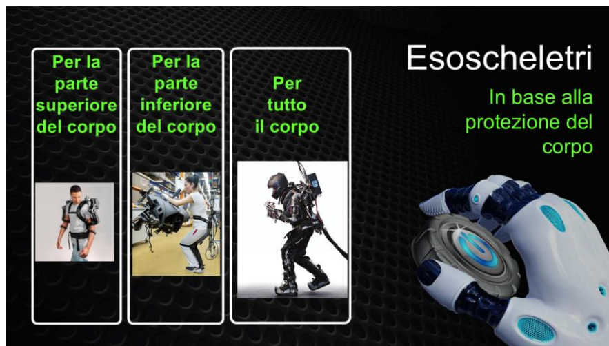
Figura 12. La slide raffigura la suddivisione degli esoscheletri distinti in base alla parte del corpo ove esercitano loro protezione 53 .
