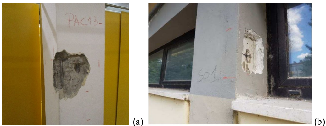
Fig. 63. Saggi e prove pacometriche con misurazione dei diametri delle barre di armatura su un pilastro del piano terra individuato in pianta con cerchio rosso (a); prove sclerometriche ed ultrasoniche su un pilastro del piano terra individuato con cerchio blu (b)
