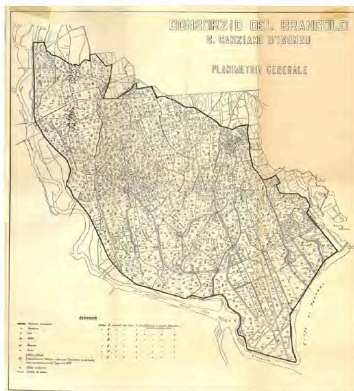
Figura 6 | Planimetria dell'opera di bonifica promossa dal Consorzio del Brancolo di San Canzian d'Isonzo. Fonte: (Gruber Benco, 1941).
