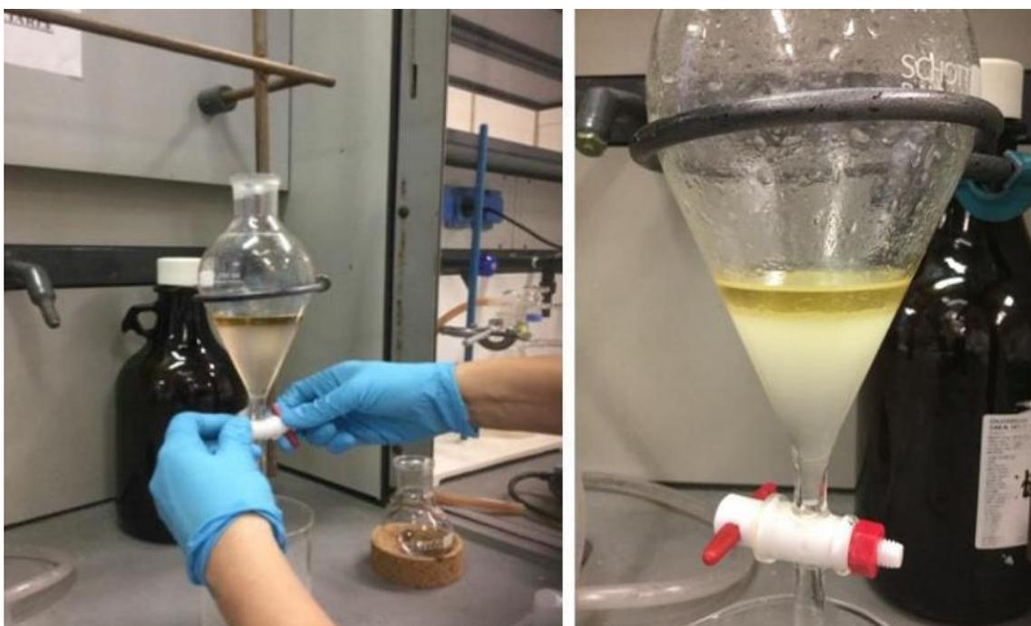
Figura 1. Sintesi dell'acetato di isopentile (Fonte: foto tratte dalle relazioni di laboratorio presentate dai corsisti relative al modulo di Chimica organica).
