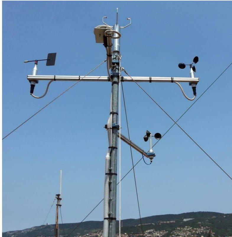
Foto 1 - Anemometri Nesa (direzione e velocità) sul supporto W-E; anemometro sonico Thies in testa; anemometro a coppe Thies 1 a classe a NNE.
