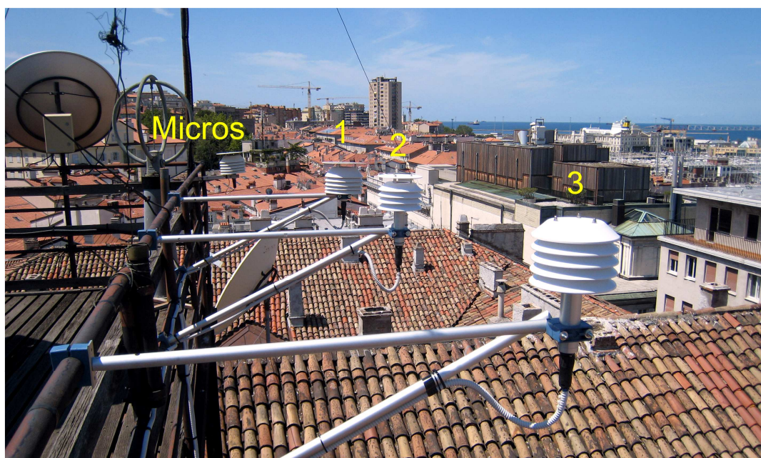
Fig. 9- Schermi passivi alla stazione di Trieste. (Micros) STEP Istituto Nautico. Stazione dell'Università, sensori Nesa: (1) schermo STEP, (2) schermo UTA modificato, (3) schermo UTA standard.
