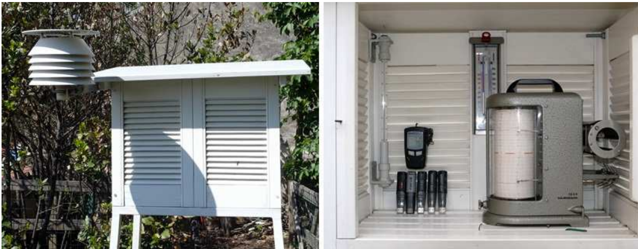
Fig. 6.- Stazione di Crogole (San Dorligo della Valle, 2012): capannina tradizionale in legno e schermo STEP, muniti di termoigrometri registratori (dataloggers).
