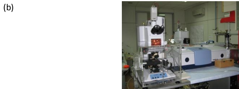
Figura 4: Rappresentazione schematica (a) e immagine dello spettroscopio ad infrarosso (b) della linea di luce SSSI presso il Sincrotrone di Elettra, Trieste.
