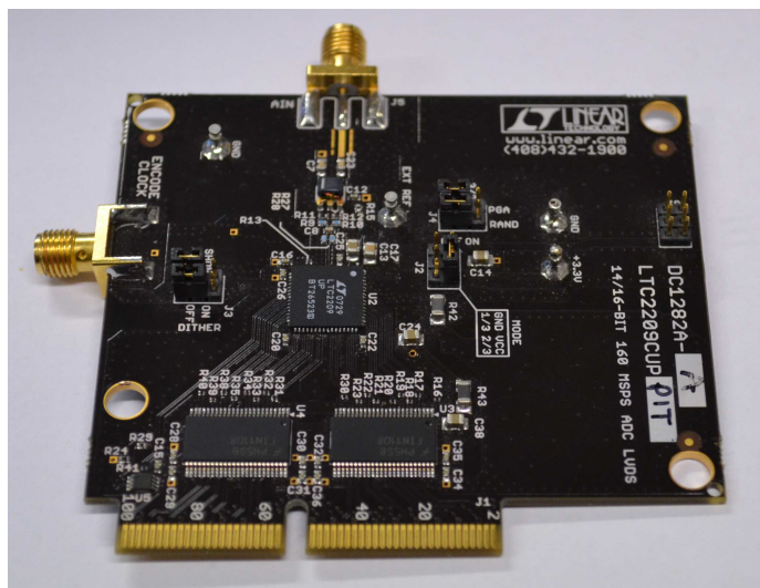
Figura 55: Scheda di valutazione dei convertitori LTC2209.
