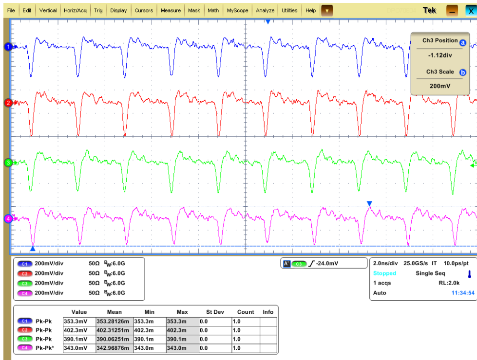
Figura 28: Tensione misurata in uscita dai quattro pick-up con un oscilloscopio: si possono vedere le forme d'onda corrispondenti alla derivata dei singoli bunch.
