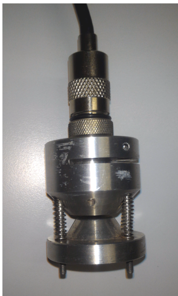
Figura 4.18: Foto della cella di misura realizzata per il trasduttore Panametrics V358
