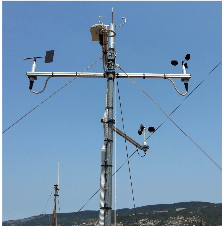
Anemometri Nesa (direzione e velocità) sul supporto W-E. Anemometro sonico Thies in testa. Anemometro a coppe Thies 1 a classe a NNE.
