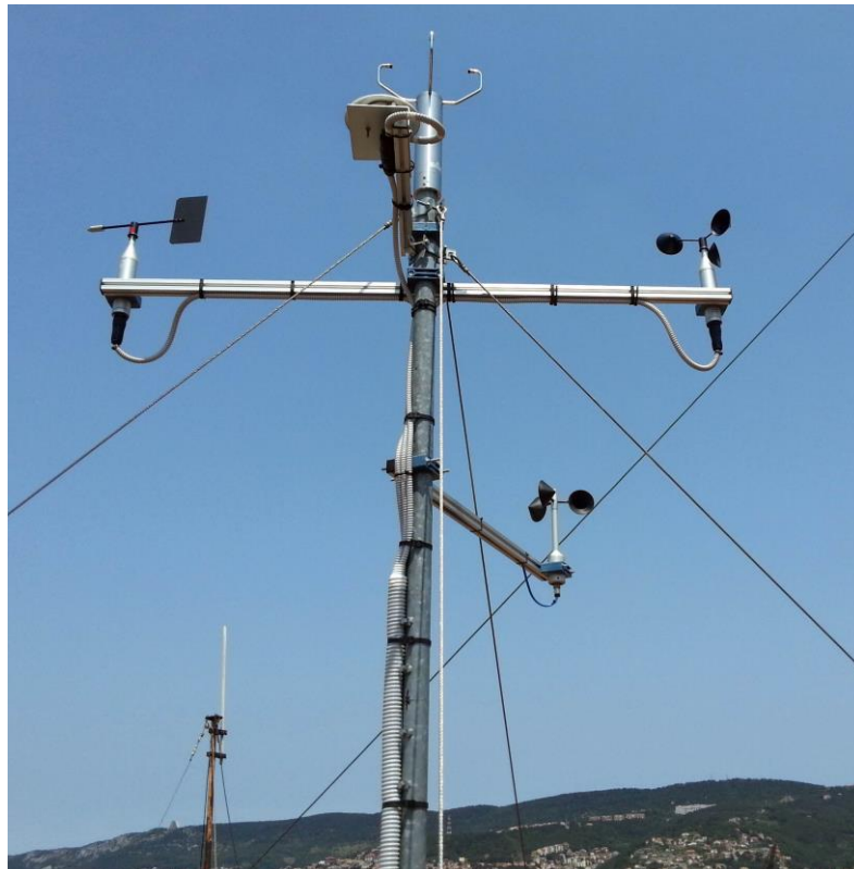
Foto 1 - Anemometri Nesa (direzione e velocità) sul supporto W-E; anemometro sonico Thies in testa; anemometro a coppe Thies 1ª classe a NNE.
