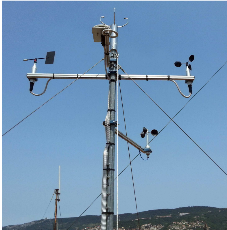
Anemometri Nesa (direzione e velocità) sul supporto W-E. Anemometro sonico Thies in testa. Anemometro a coppe Thies 1ª classe a NNE.
