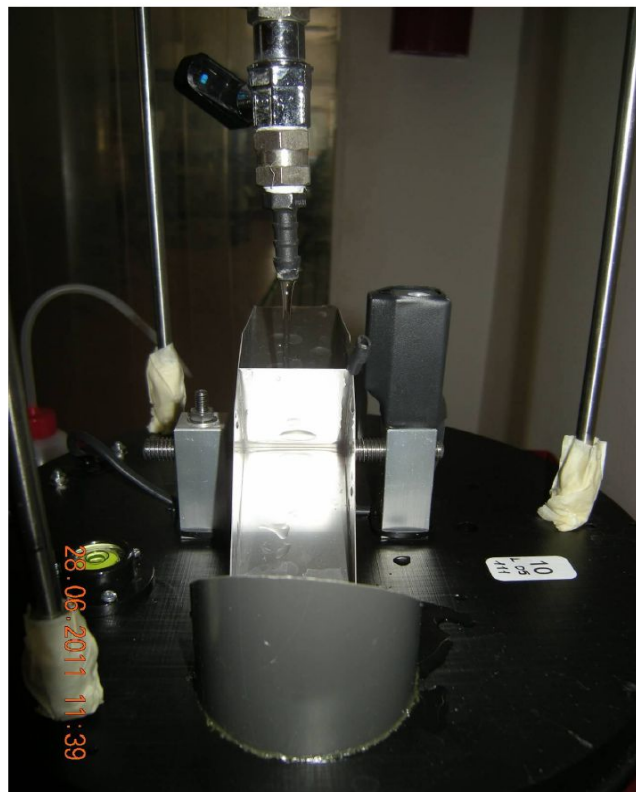
Fig. 7 - Caduta dell'acqua nella bascula (vista laterale).
