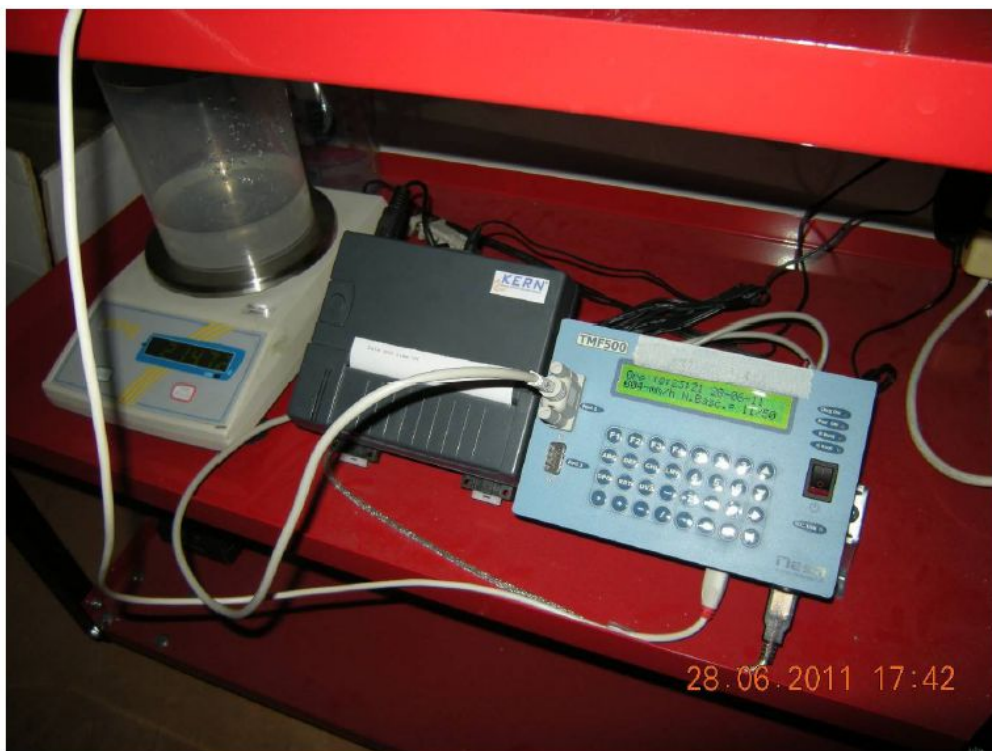
Fig. 5 - Sistema di acquisizione dati.
