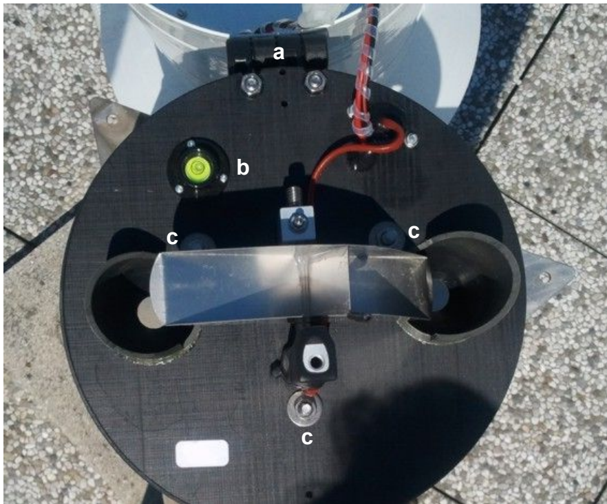
Fig. 3 - Vista dall'alto del pluviometro aperto. Sono visibili la cerniera (a), la bolla sferica (b), la bilancia (c) e le 3 viti di regolazione (d).
