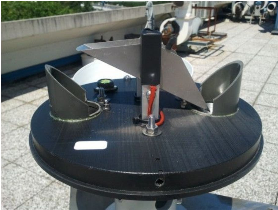
Fig. 2 - Interno del pluviometro aperto.
