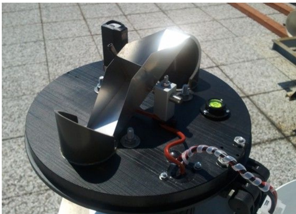
Fig. 4 - Collegamenti elettrici, contatto magnetico e riscaldatore.
