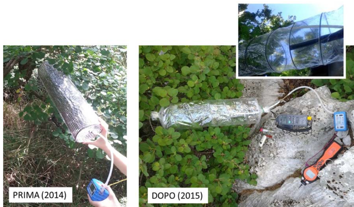
Figura 2.9: sistema di campionamento branch-enclosure utilizzato nel 2014 (a sinistra) e successivamente modificato (a destra); in alto dettaglio dell'interno della sacca, munito di sonde per la misurazione dei parametri microambientali.
