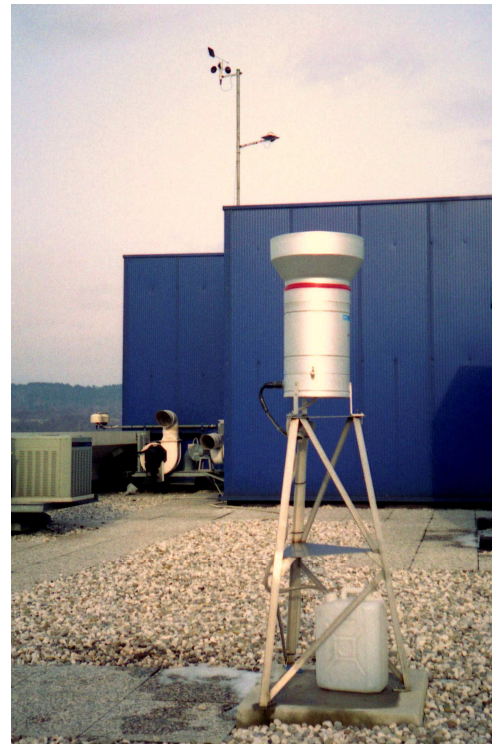
Fig. 4.- Tetto dell'edificio "B": (1) unità di acquisizione dati e modem, (2) sensori di temperatura e umidità relativa dell'aria, (3) anemometro e piranometro, (4) pluviometro.
