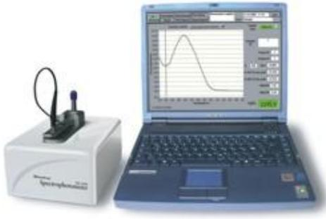
Il DNA estratto è stato quantificato e ne è stata valutata la purezza per mezzo della lettura allo spettrofotometro (Nanodrop 1000 V3.7.0, Thermo Scientific). Un microlitro di campione viene appoggiato sull'estremità di un cavo a fibre ottiche (*receiving fiber*) mentre un secondo cavo a fibre ottiche (*source fiber*) viene
