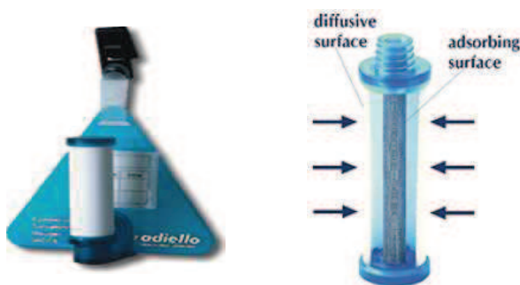
Fig. 2.10 Campionatore Radiello con particolare della cartuccia assorbente (fonte: www.sigma-aldrich.com )
