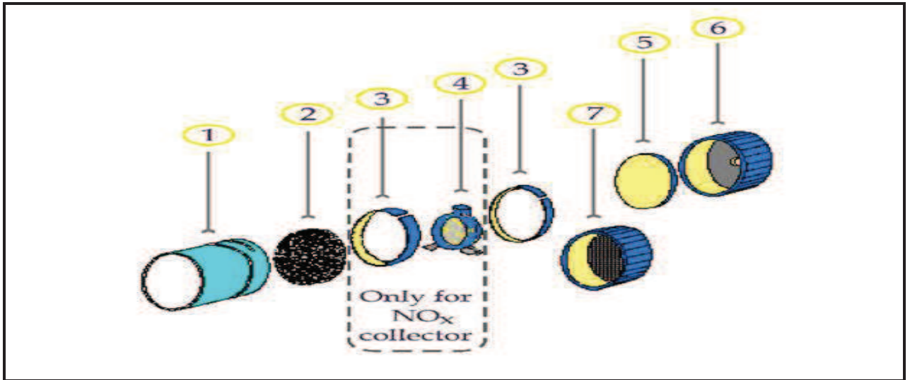
Figura 2.8 - disegno esploso del campionatore passivo Analyst per NO x . 1 = cilindro di contenimento, 2 = ossidante; 3 = anello di tenuta in acciaio inox; 4 = supporto e superficie adsorbente; 5 = guarnizione; 6 = tappo filettato in plastica; 7 = barriera antiturbolenza (fonte Manuale Operativo ANALYST – 07/12 – rev. 5)
