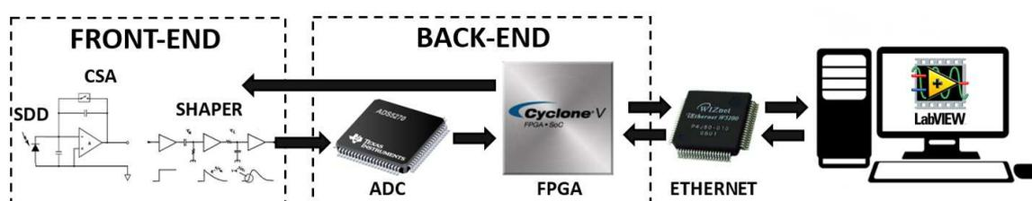
Figura 5.1: Schema semplificato del sistema completo: il segnale analogico in uscita dal front-end viene digitalizzato dall'ADC ed elaborato dall'FPGA. L'FPGA comunica in seriale i dati al chip *WIZnet* che li trasmette via TCP/IP a un PC dove risiede un software creato in LabVIEW, nel quale è implementata un'interfaccia utente.
