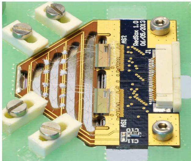
Figura 6.1: Assemblaggio del primo prototipo. Si noti i lunghi wire bonds che collegano i due ASIC VEGA agli anodi del rivelatore, responsabili del deterioramento della risoluzione energetica.
