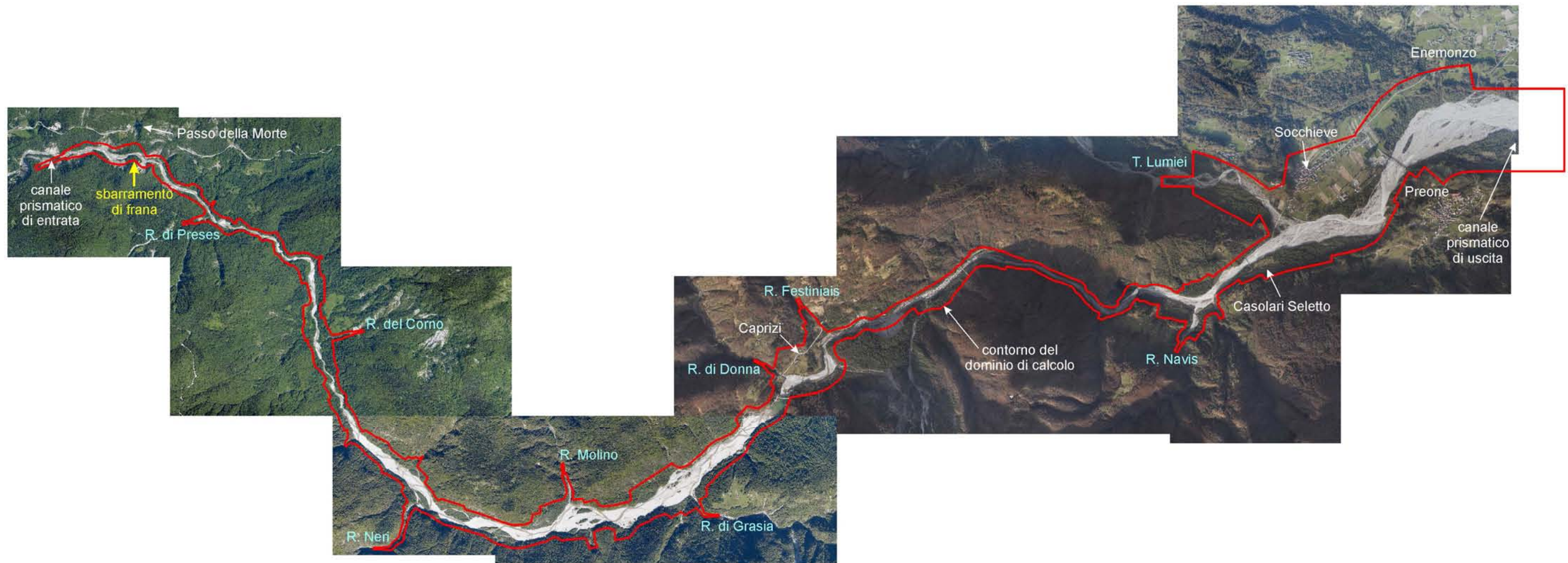
Fig. 9.14 Contorno del dominio di calcolo (in rosso) sovrapposto a ortofoto del tratto d'asta del F. Tagliamento analizzato nelle simulazioni idrodinamiche della propagazione dell'onda di piena conseguente alla rottura del potenziale sbarramento di frana in località Passo della Morte. Sono indicati gli affluenti del F. Tagliamento considerati nelle analisi.
