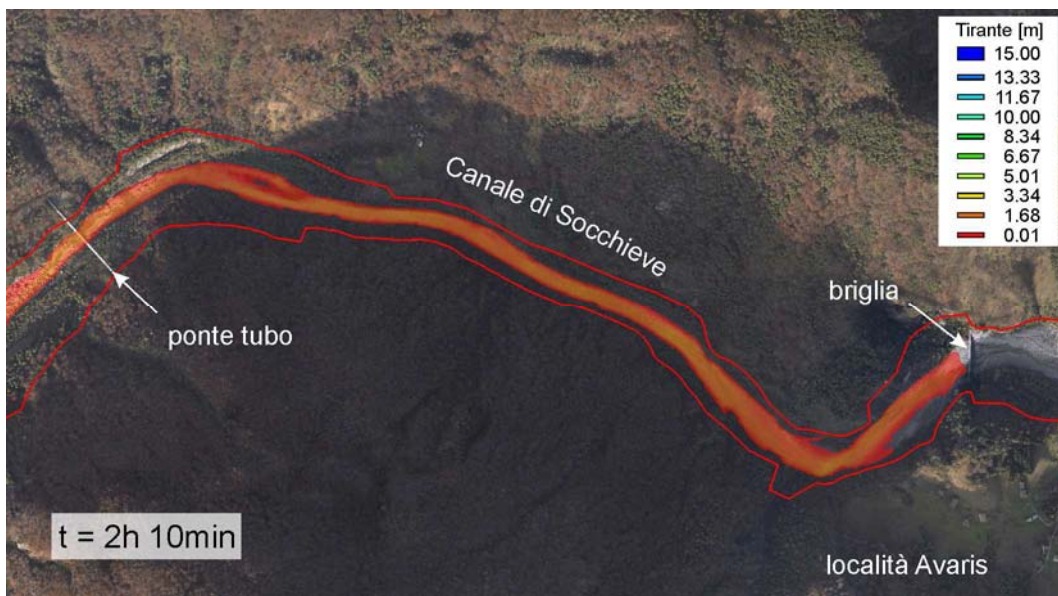
Fig. 9.23 Tiranti simulati dell'onda di piena che si propaga su fondo asciutto, lungo il Canale di Socchieve tra gli abitati di Caprizi e Socchieve.
