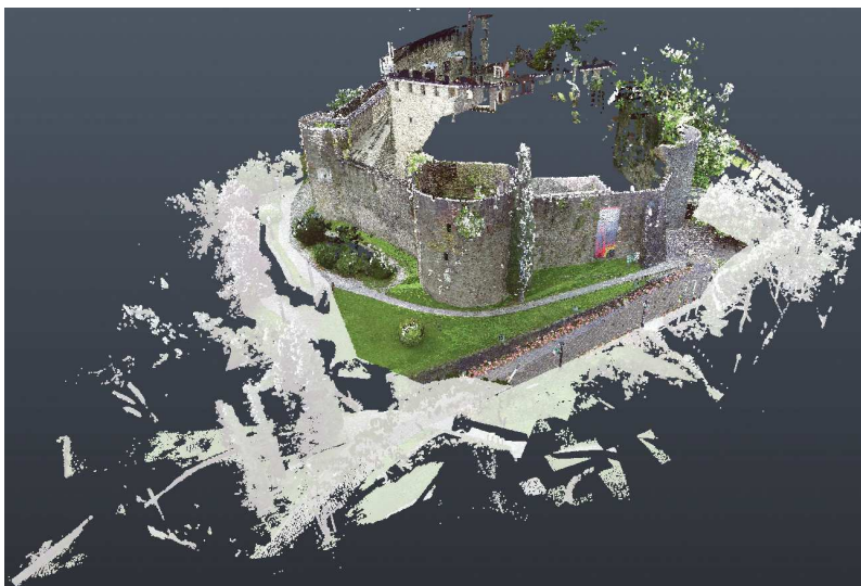
2.33_In questa visione della nuvola sono stati evidenziati in bianco tutti i punti che fanno parte dell'intorno e non sono utili all'individuazione della geometria del castello.
