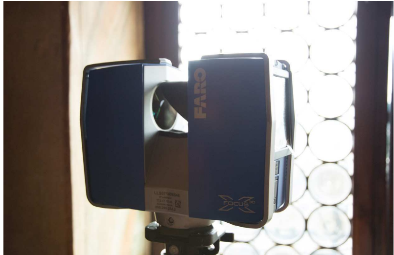
2.23_Scanner Laser 3D Faro CAM2 in azione all'interno di una sala del castello.
