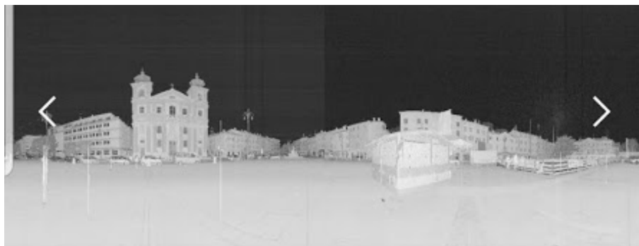
Fig. 164 - Anteprima panoramica di una scansione laser scanner eseguita all'esterno della chiesa di Sant'Ignazio grazie alla tecnologia WLAN che permette il controllo remoto dello scanner.
