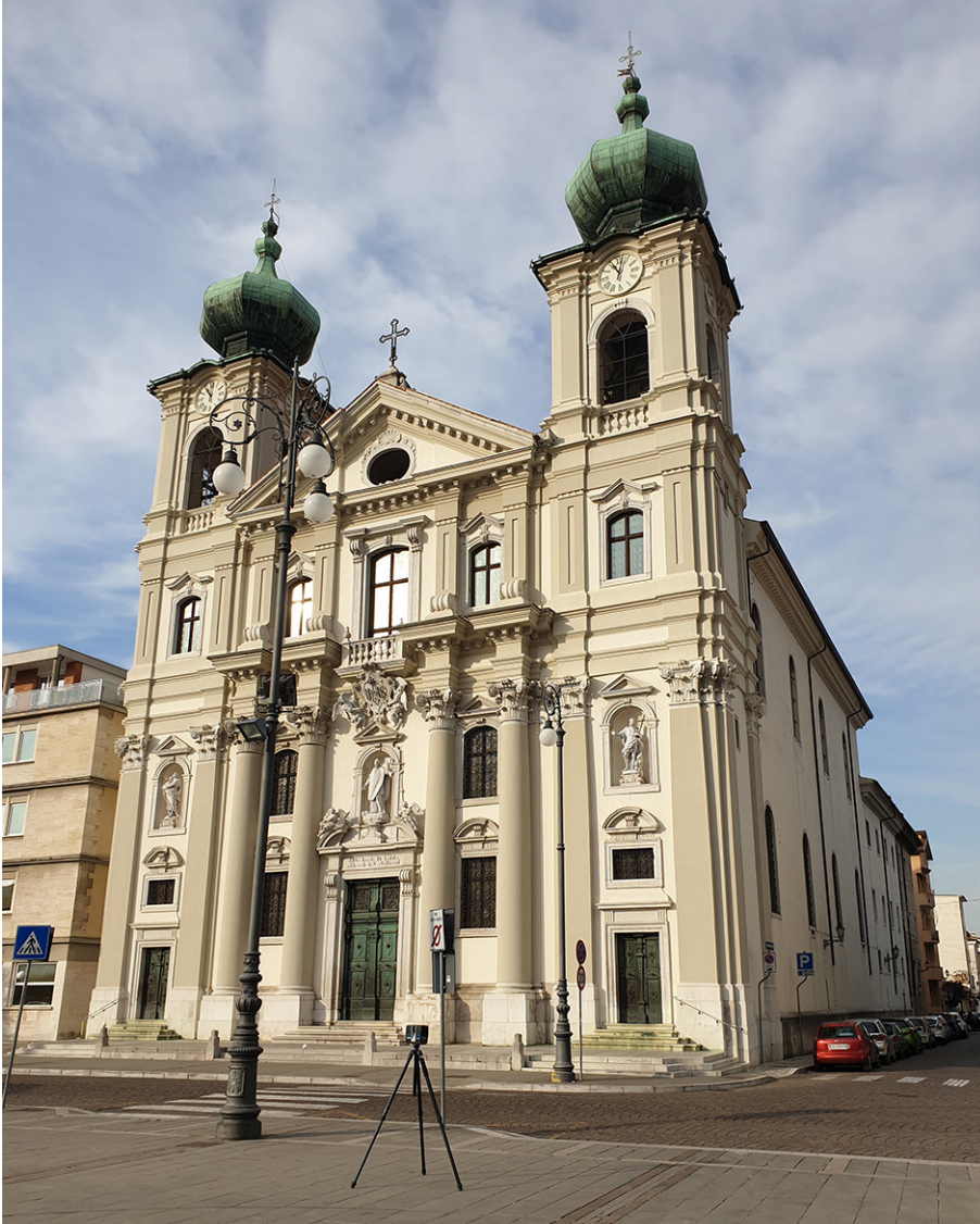
Fig. 162 - Campagna di rilievo laser scanning all'esterno della Chiesa di Sant'Ignazio Confessore di Gorizia.
