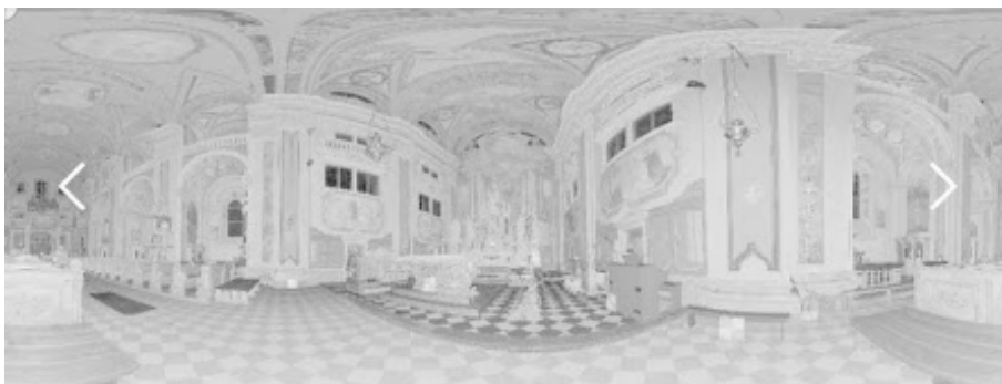
Fig. 165 - Anteprima panoramica di una scansione laser scanner eseguita all'interno della chiesa di Sant'Ignazio. Controllo remoto dallo smartphone.
