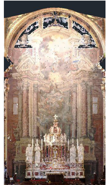
Fig. 190 - Porzione di nuvola di punti ottenuta con scansione laser all'interno della chiesa.
