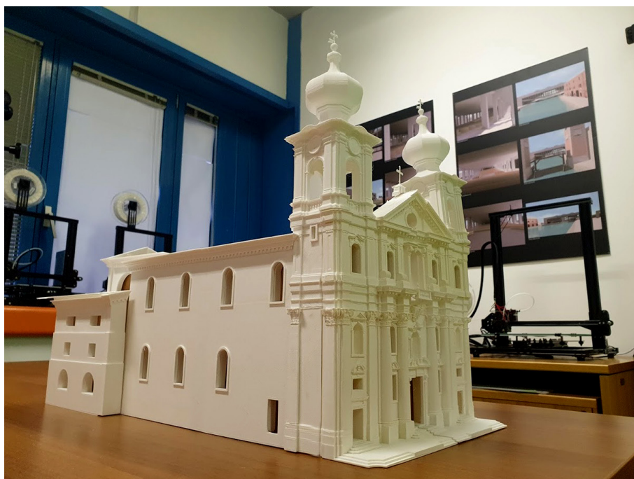
Figg. 216-217 - Campanile della Chiesa di Sant'Ignazio: predisposizione parametri di stampa e avvio prototipazione.
