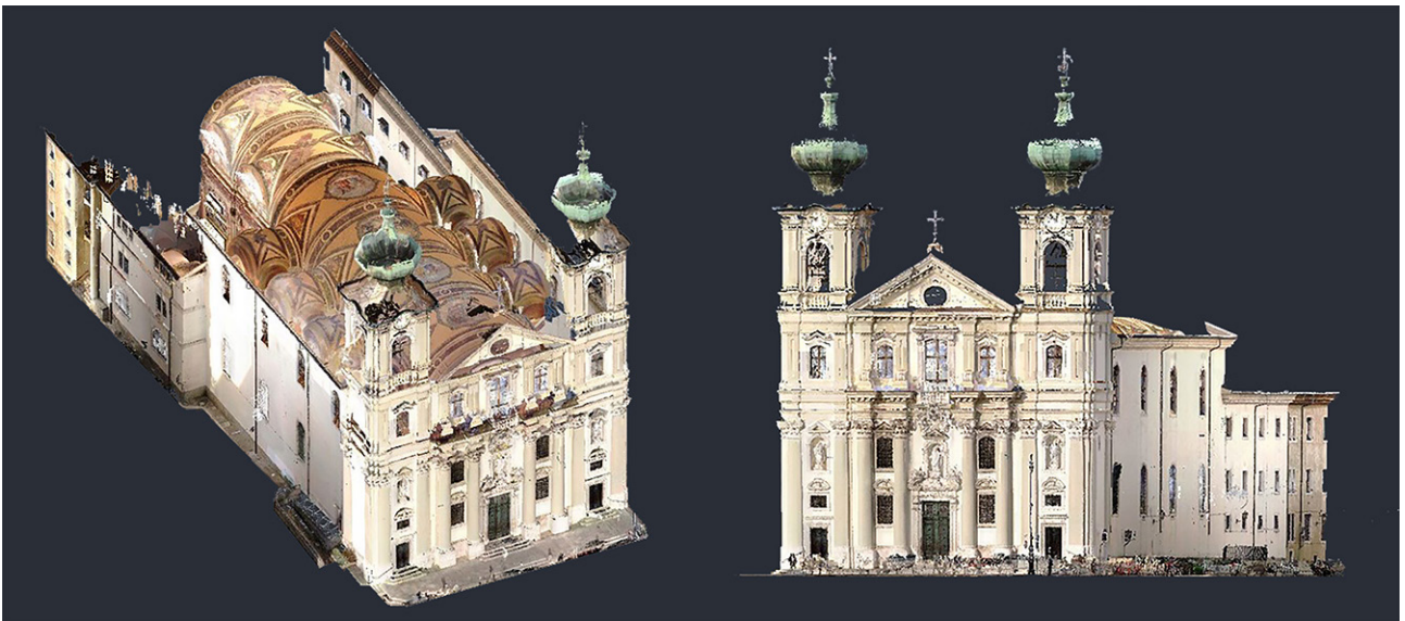
Fig. 166 - Nuvola di punti risultante dall'unione delle scansioni laser. (3DF Zephyr)
