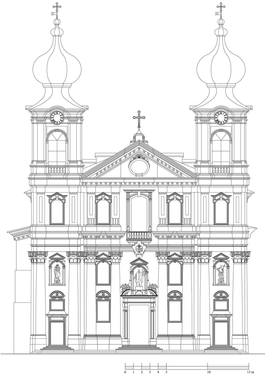
Fig. 169 - Modelli assonometrici in ambiente Autodesk Autocad della chiesa di Sant'Ignazio di Gorizia secondo le informazioni della nuvola di punti. (Elaborazione dell'autrice)
