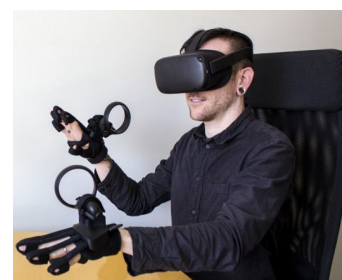
Fig. 102 - “Forte Data Gloves – A Haptic Feedback, Finger Tracking Glove” utilizzato con visore Oculus Rift.
