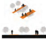
In corrispondenza dei tratti di percorso all'interno della città sono state progettate delle zone 30 con riduzione della sezione stradale attraverso l'inserimento di parcheggi e alberature.
