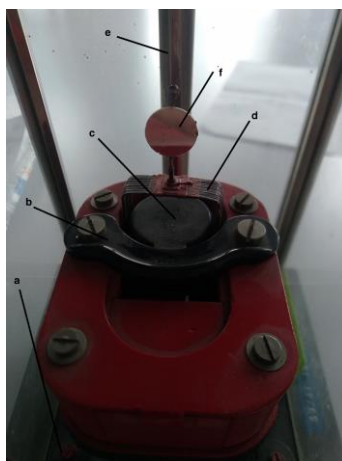
Figura 3. Le componenti del galvanometro Deprez-D'Arsonval (a. morsetti; b. magnete permanente; c. cilindro di ferro; d. bobina; e. filo di torsione metallico; f. specchio) (Foto: S. P. Leban).
