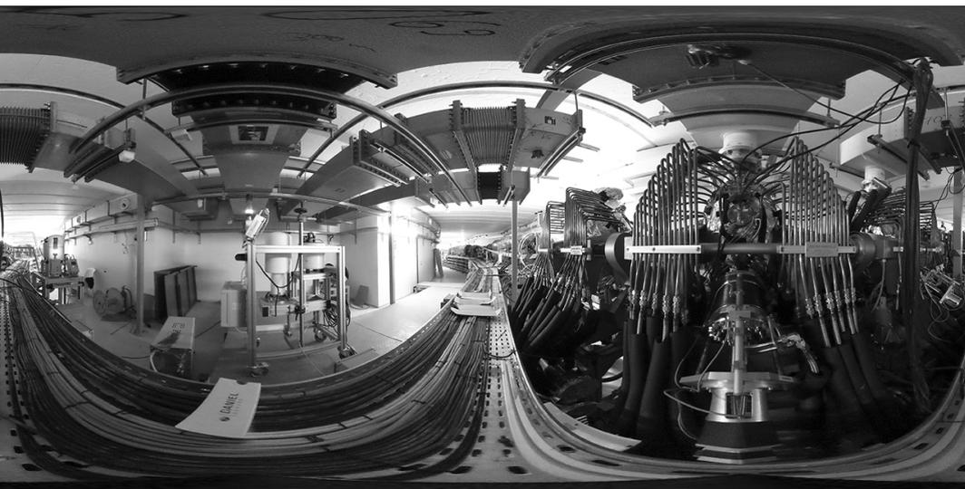
Fig. 3. Panoramica dell'interno del tunnel dell'anello di accumulazione di SESAME. I dispositivi sulla destra sono tre delle quattro cavità realizzate in Italia con parte del contributo italiano a SESAME.
