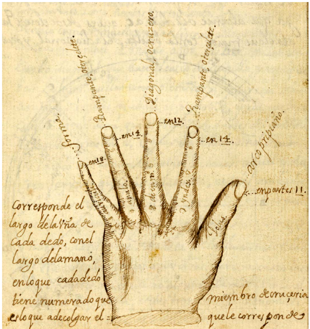
Fig. 12. TRodrigo Gil de Hontañón, Compendio de architectura... (1681), p.26: descrizione del sistema di archi di una volta nervata attraverso l'analogia anatomica con la mano umana, Rodrigo Gil evidenzia anche il rapporto proporzionale tra la lunghezza delle unghie e quella delle dita.
